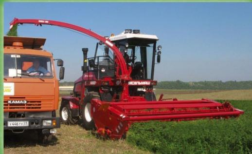
**Жатка для трав.** Система копирования рельефа поля и установка высоты среза гарантирует одинаково ровный срез. Обгонная муфта шкива привода мотовила предотвращает повреждение мотовила при обратном вращении шкива.
